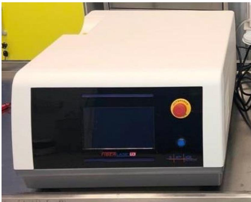
Рисунок 21 – Тулиевый лазерный аппарат Fiberlase U2 (IPG, Россия)
