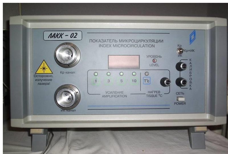
Рисунок 5 – Лазерный анализатор микроциркуляции крови ЛАКК-02, вид спереди
