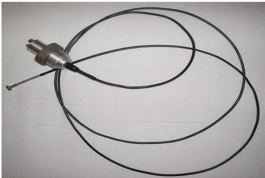
Рисунок 6 – Базовый световодный зонд для чрезкожных исследований микроциркуляции
