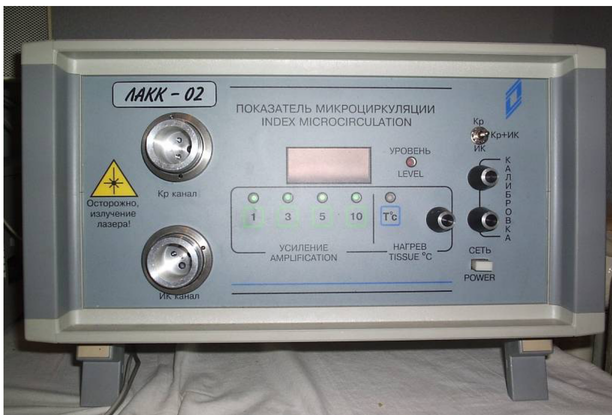
Рисунок 2 – Передняя панель лазерного анализатора микроциркуляции крови ЛАКК-02
