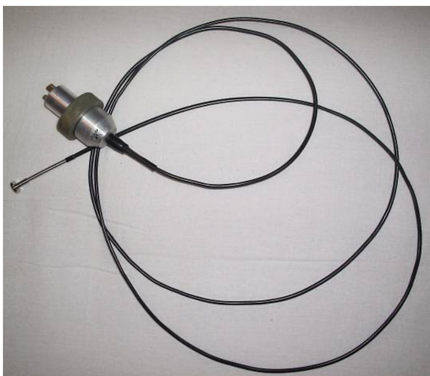
Рисунок 3 – Базовый световодный зонд для накожных исследований микроциркуляторного кровообращения
